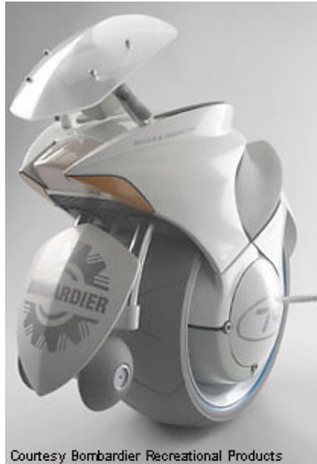
Abbildung 68 Studie eines motorgetriebenen, selbstbalancierenden Einrades der Firma Bombardier, Modellfoto
