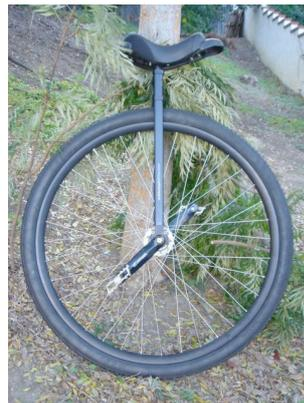
Abbildung 51 36 Zoll Schlumpf Getriebeeinrad
